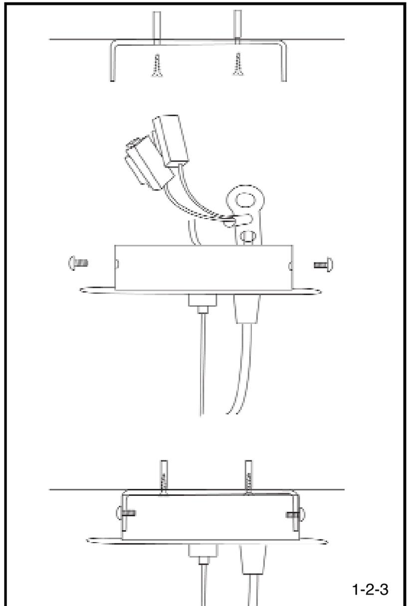
4- Entrer la structure support de douille à l'intérieur de la sphère en la faisant pivoter puis aimanter la structure à la patte de suspension à travers l'abat jour de papier
